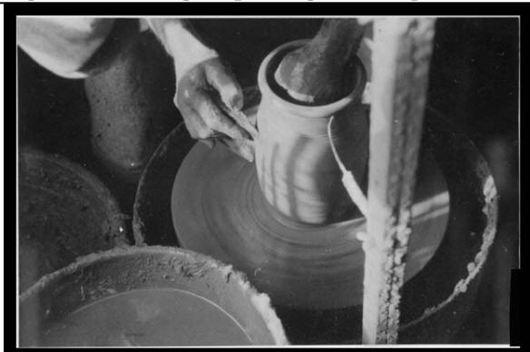
Figure 28 - Enflage et polissage à l'estèque 04
