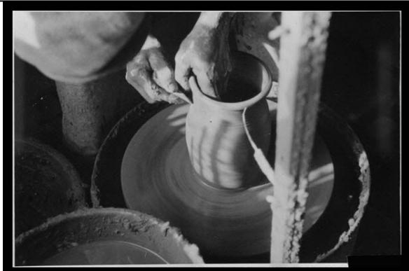
Figure 26 - Enflage et polissage à l'estèque 02
