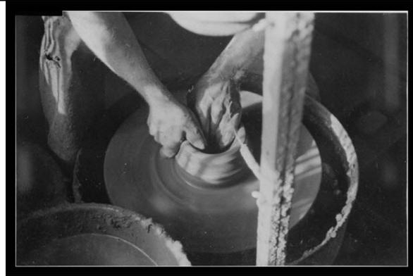
**Figure 21 - Mise au diamètre 2eme mouvement**
