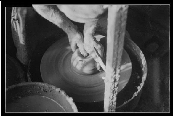
**Figure 20 - Mise au diamètre 1er mouvement**
