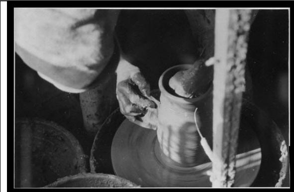
Figure 33 - Enlage et polissage à l'estèque 2
