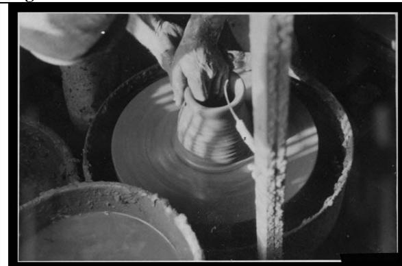
Figure 31 - montée de la paroi latérale
