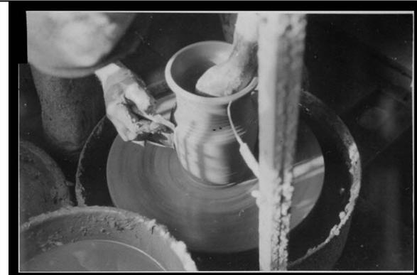
Figure 25 - Enflage et polissage à l'estèque 01
