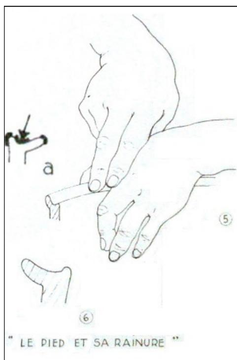
**Figure 135 - fabrication d'un mahon de trois : tracé de la rainure**
