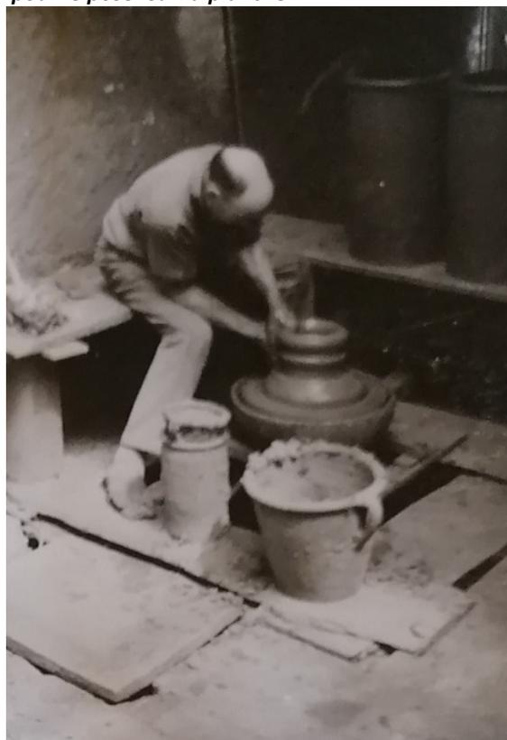
*Figure 66 - Fabrication d'un mahon : montée de la terre*
