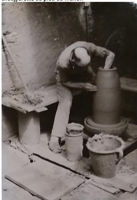
**Figure 74 - Fabrication d'un mahon : soudure des 2 parties**
