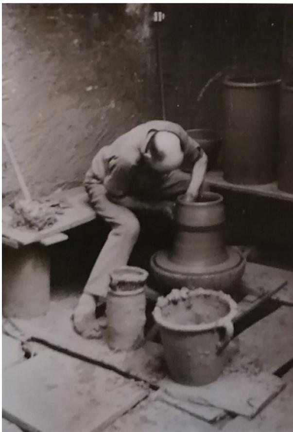
**Figure 71 - Fabrication d'un mahon : montée du pied**
