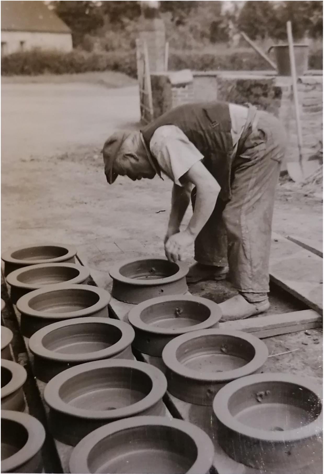
**Figure 90 - enfourneurs perforés par un manoeuvre**
